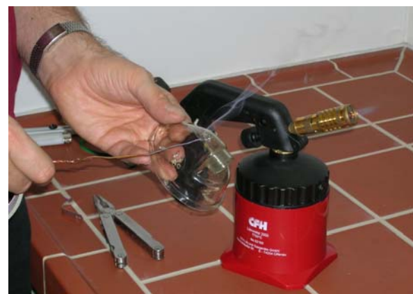
Beilsteintest zur Untersuchung des möglichen PVC-Gehaltes
